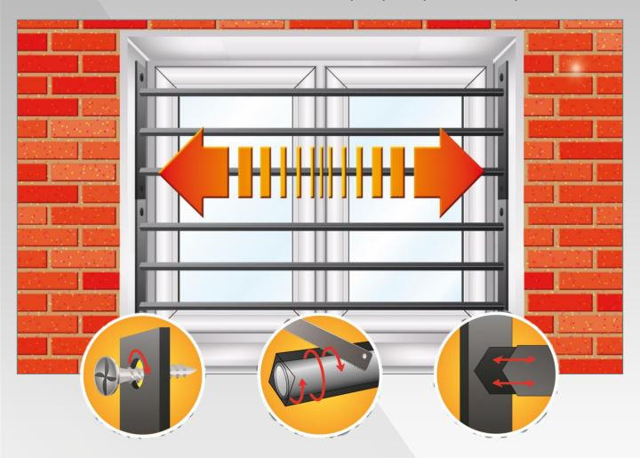
Sans soudure – Système télescopique
