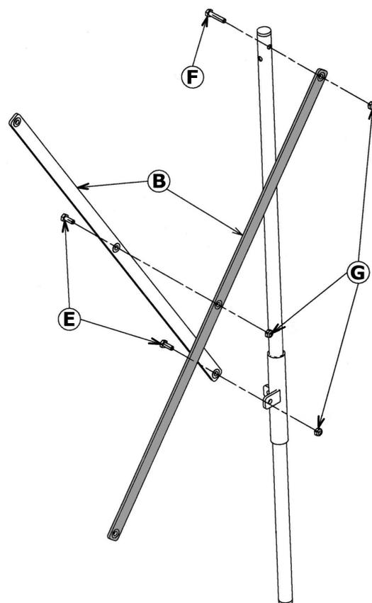
Positionner les bossages des barres **B** face à face, de façon à limiter les frottements.
